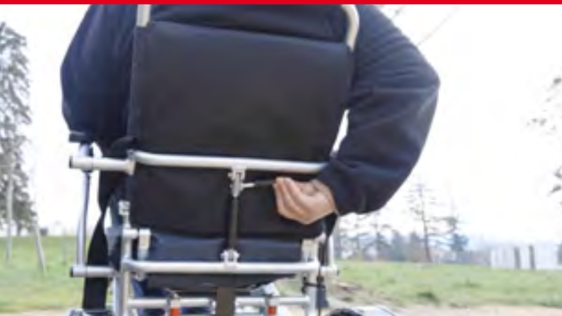
Inclinaison de dossier par vérin à gaz
